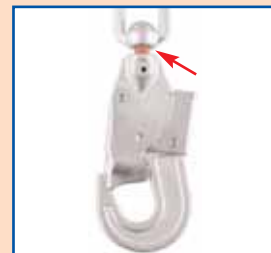
Mosquetón con testigo de caída, después de la caída
